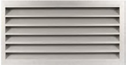
Aluminium-Wetterschutzgitter mit geringer Einbautiefe. Die besondere Lamellenform beschränkt die Gefahr von Regenwassereinschlag auf ein Minimum. Das Gitter kann wahlweise mit 2 verschiedenen Frontrahmen geliefert werden: Mit Flansch für den Wandvorbau F-WV oder zum flächenbündigen Wandeinbau F-WE
